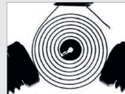
TC1MHR テレセントリックレンズ を使用した精密フラットコイルス プリングの測定
