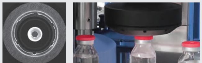
PCCD レンズの F/# が低いいため、高速化が可能になります。
