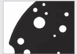
TCLWD3M レンズとバックライト照明を使用した時計の歯車の測定
