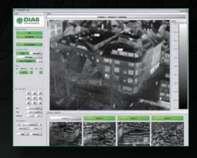
火災検知の場合: PYROSOFT FDSをインテリジェントな早期火災検知システム PYROVIEW FDSと組み合わせて使用すると、火災に短時間で対応できます。 カメラはパン チルトヘッドに取り付けることができるため、連続するセクターの監視エリアをカバーできます。
