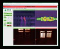
リモートアクセスの場合: PYROSOFT Clientを使用して、別のネットワークPC上のPYROSOFT アプリケーションとのデータ接続を確立します。そのため、最新のカメラ画像とステータス情報を取得 できます。接続されたPYROSOFTアプリケーションはサーバーとして機能し、データを提供します。
