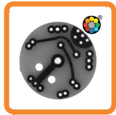
バックライト FluoreSheet ™ (BF590) 青色 LED オレンジのバンドパスフィルター (BP590)
